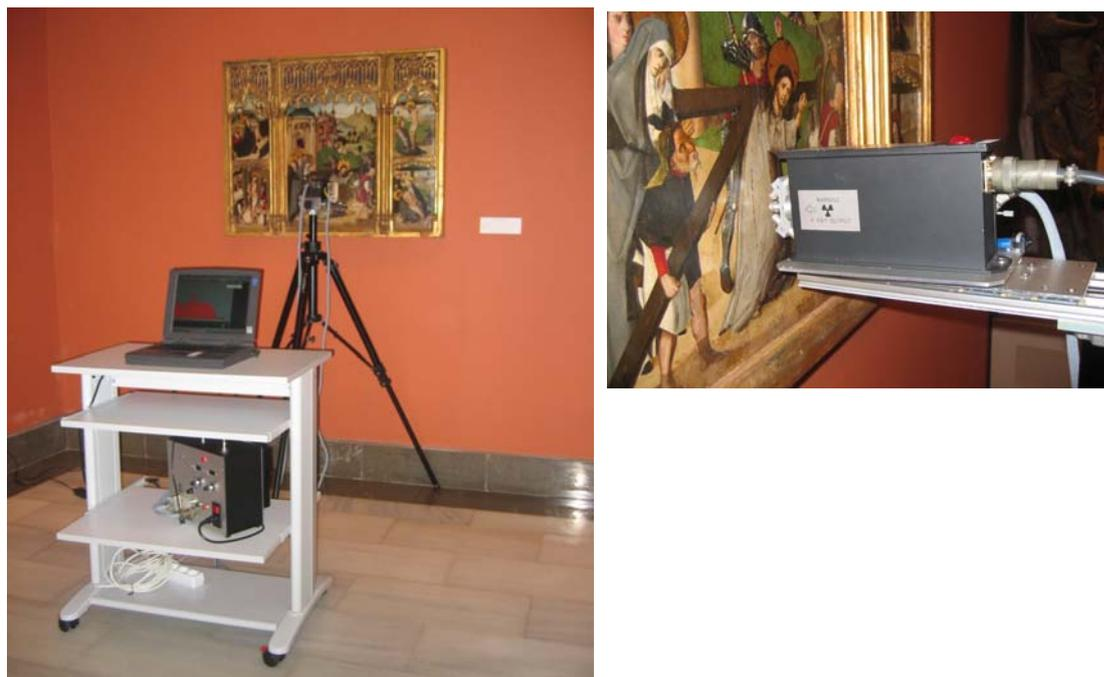
*Fig. 2. XRF análisis in situ.*
