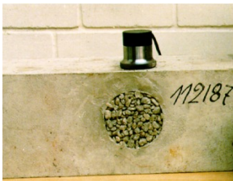
Abb. 5: links Betonprobe mit Kiesnest und Impuls-Echo-Prüfkopf, rechts Bt-Bild von einer Betonprobe mit Riss
