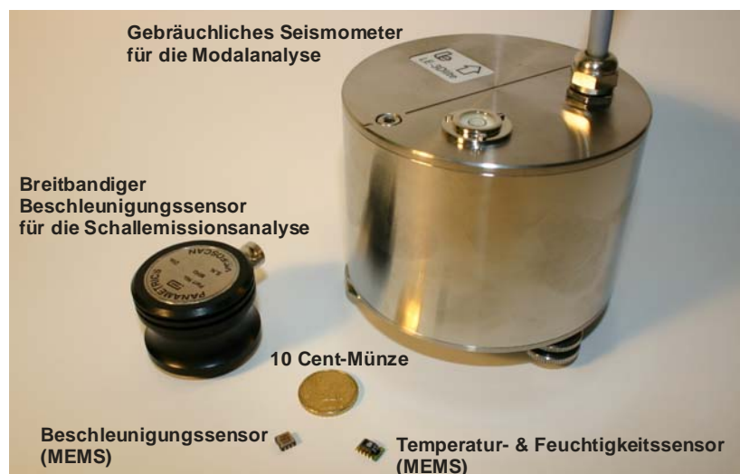
Abbildung 3: Konventionelle und MEMS-basierte Sensorik für das Bauwerksmonitoring
