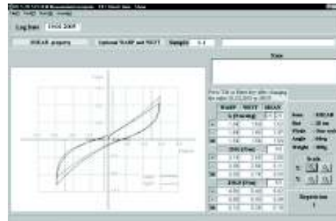
Obr.6 Měření vzorku smykem
