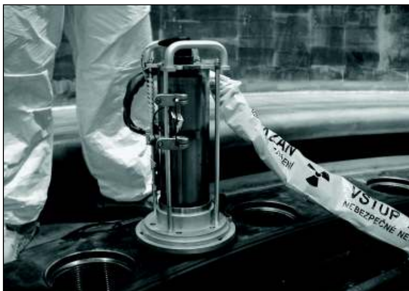
Manipulátor JEKOZ (zkoušení HDR - ETE)
