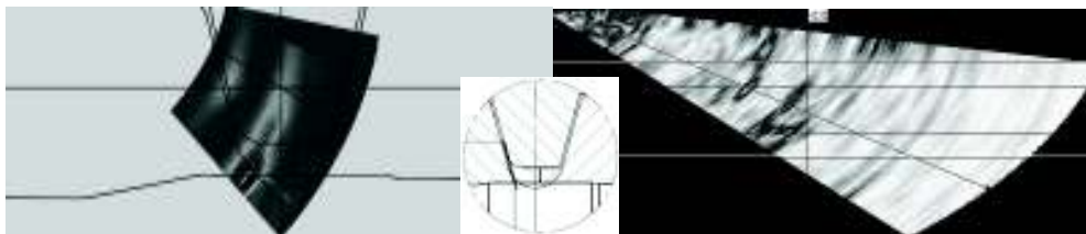
Obr. 7: S-scany získané při simulaci a měření defektu 1Ho5
