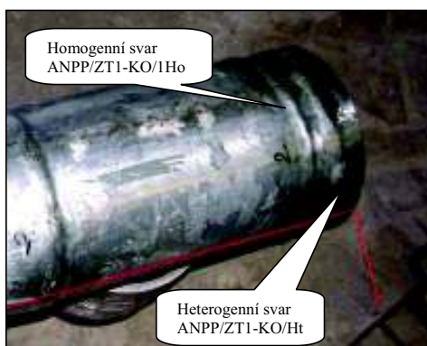
Obr. 2: Model zkušební tělesa ANPP/ZT1-KO
