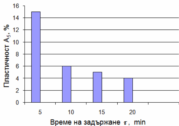
Фиг. 2. Пластичност на материала A_5 при изпитване на студено във функция от времето на задържане \tau при режим 1
