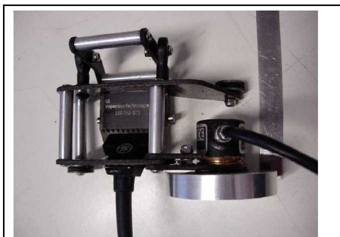
Figura 4: carrello e sonda con encoder per saldature lineari.
