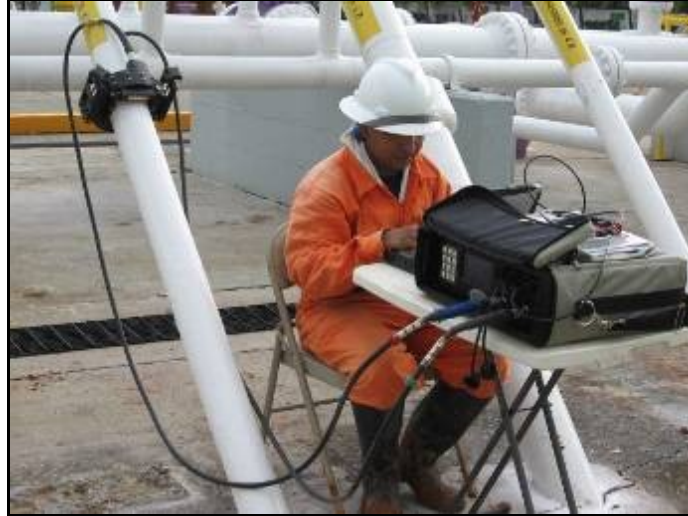
Figura 3. Wavemaker kit usato in site-test nel caso di tuberia aerea (con penetrazione terreno).
