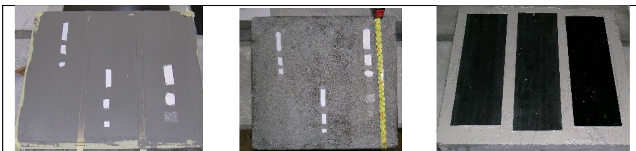
Figura 7 - Sistemazione difetti artificiali, primo campione
