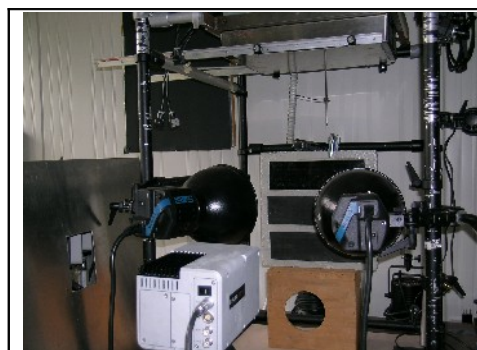
Figura 10 - Apparecchiature utilizzate per i test termografici sui campioni
