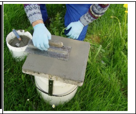
Figura 3 - Aspetto del provino dopo l'applicazione dell'intonaco sui tessuti FRP
