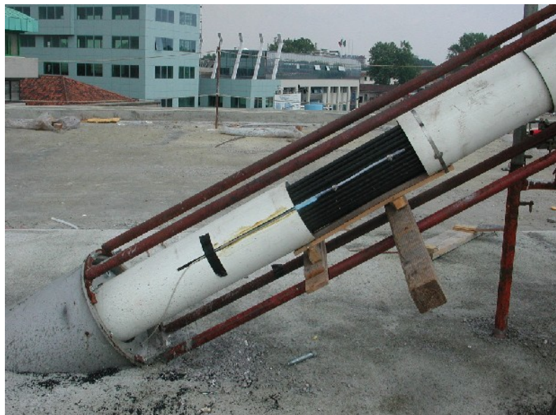
Figura 3 – Disposizione dei sensori nell'impalcato
