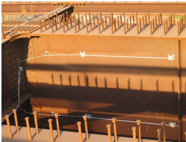
Figura 2 – Disposizione dei sensori nell'impalcato
