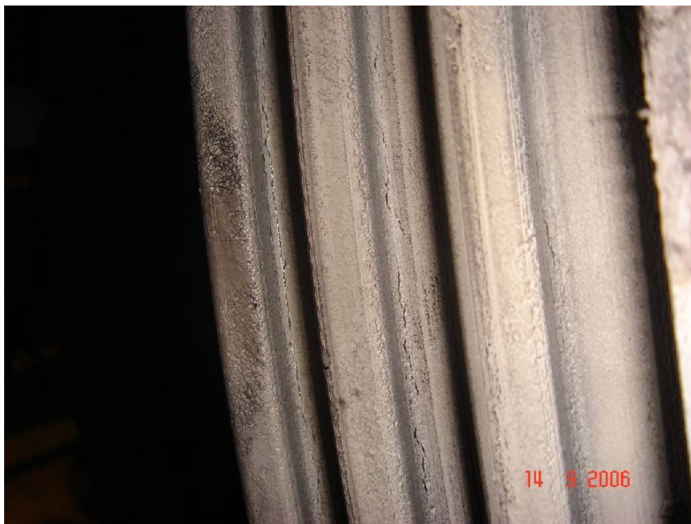
Figura 10 - Cricche rilevate con controllo MT, dopo smontaggio delle palette
