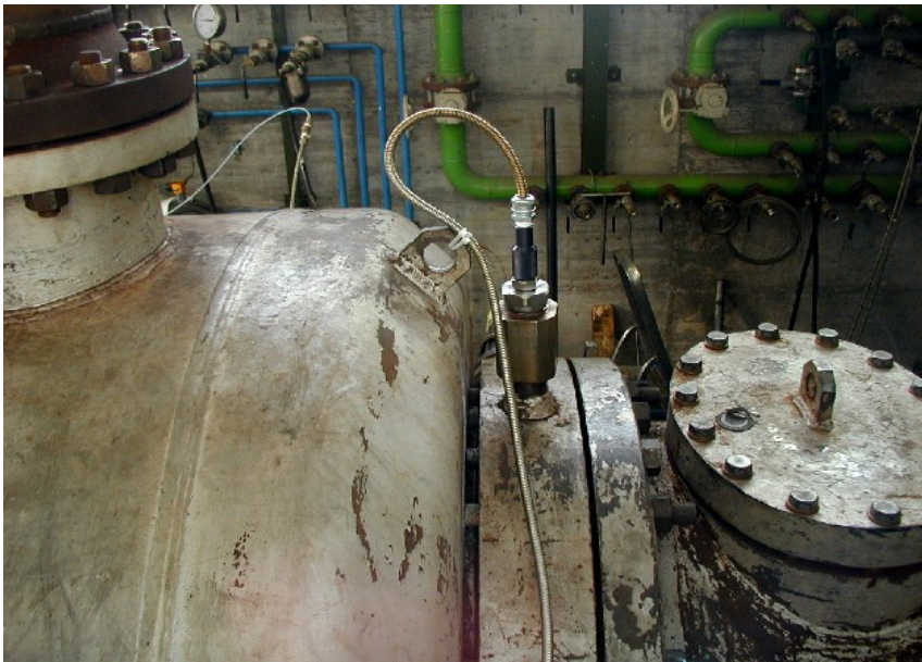
Fig. 1 - Sensore a fibra ottica montato su banco prova.
