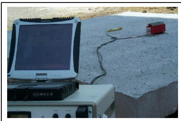
Figura 3. Misura su lastra di calcestruzzo integra.
