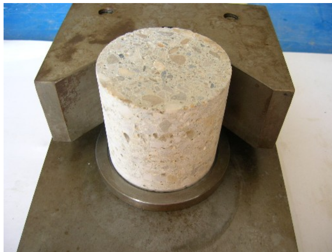
Figura 2c – Provino allocato nel dispositivo di cattura
