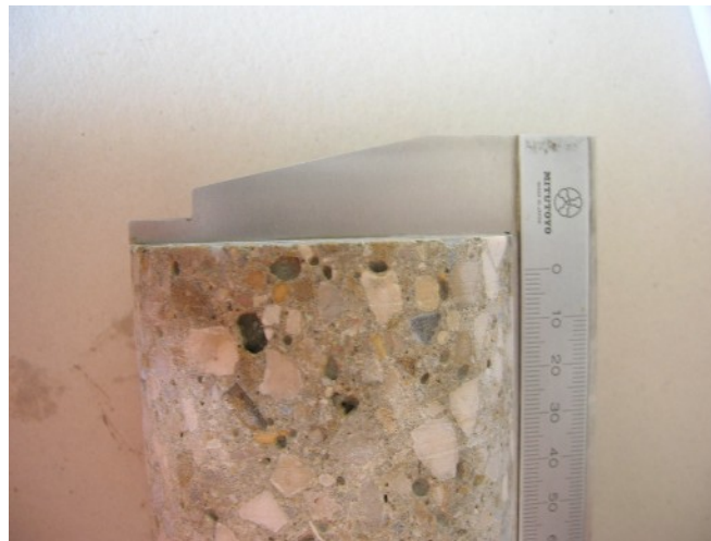
Figura 2a – Preliminare all'operazione di cappatura
