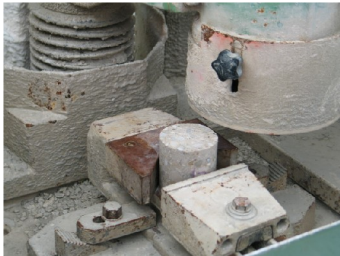
Figura 3b – Posizionamento finale del provino per l'operazione di rettifica meccanica
