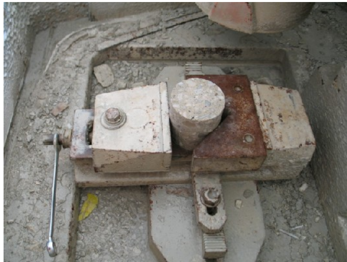
Figura 3a – Posizionamento provino per l'operazione di rettifica meccanica
