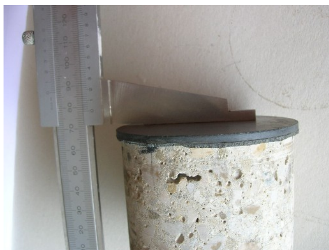
Figura 2d – Controllo della regolarità dell'operazione di cattura
