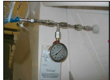
Figura 7 – Rilevazione delle fughe dal Nodo 3 pressurizzato
