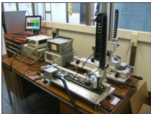
fig. 3: Sistema automatico con sonde non a contatto
