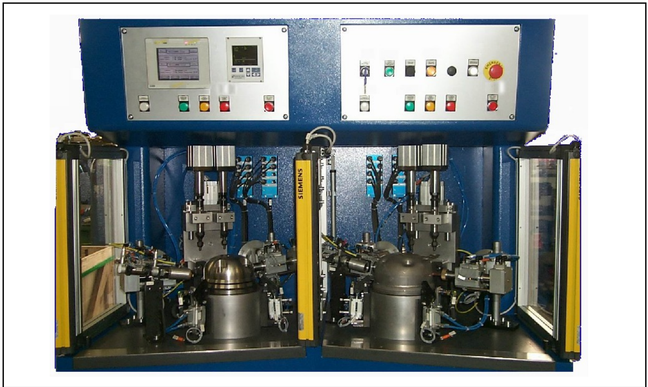
Fig. 6 - Doppia stazione di collaudo con carico e scarico manuale per alta produttività
