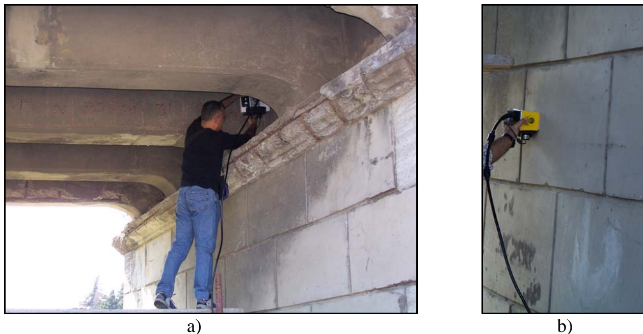
Figura 7: a) Acquisizioni Radar b) Particolare dell'Antenna di 2 GHz
