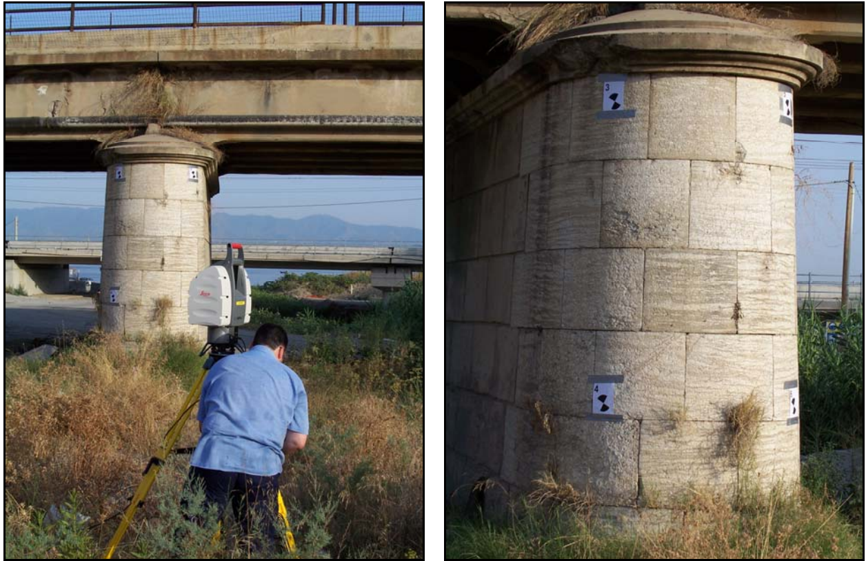
Figura 3: Viste dai vari punti di presa durante le scansioni e dei targets utilizzati
