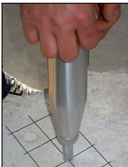
Figura 3: a) Battute sclerometriche b) Letture ultrasoniche
