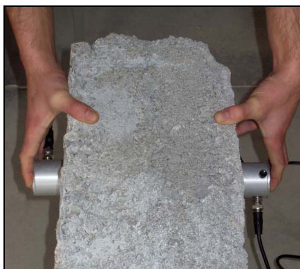
Figura 3: a) Battute sclerometriche b) Letture ultrasoniche
