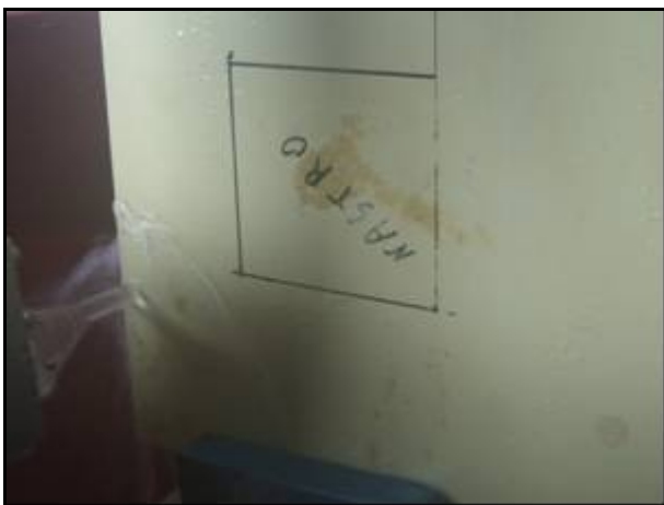
Fig. 9 e 10. Tecnica TT – Honeycomb in alluminio – il componente è tra le due sonde – la scritta nastro indica un difetto all'interno, tra il nido d'ape e il lamierino in alluminio.
