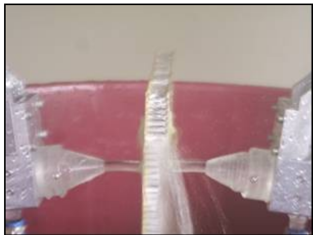
Fig. 9 e 10. Tecnica TT – Honeycomb in alluminio – il componente è tra le due sonde – la scritta nastro indica un difetto all'interno, tra il nido d'ape e il lamierino in alluminio.
