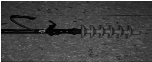
Figure 5 : *The cable terminator.*
