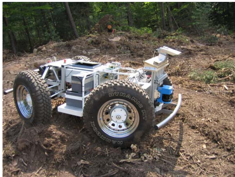
Abbildung 6: Das autonome Outdoor-Fahrzeug Ravon bei einer Testfahrt in rauem Gelände.
