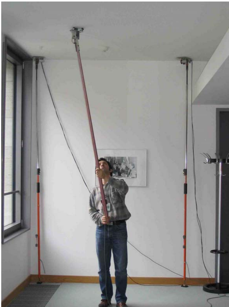
Abb. 2: Prüfung einer Gipsputzdecke mit dem DHD Verfahren
