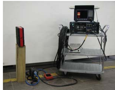
Abb. 2: Radargerät (SIR 10A) mit 1,5 GHz Antenne der Fa. GSSI.
