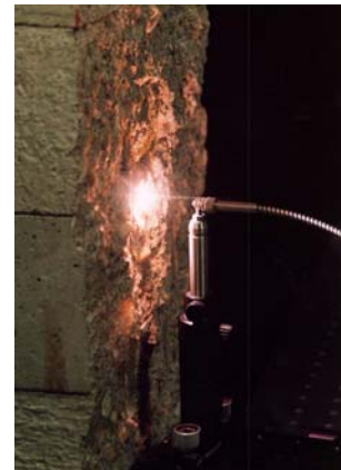
Abbildung 1: Links: Schematischer Versuchsaufbau. Rechts: Fotografie des sichtbar gemachten Laserstrahls und des Plasmas an der Oberfläche einer Baustoffprobe
