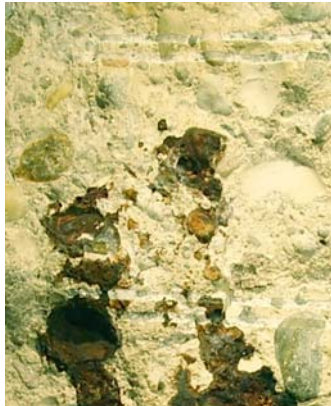
Abbildung 2 Messfläche auf der Unterseite der Probe aus einem Parkdeck.
