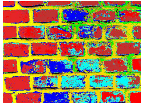
Abb. 7: Ergebnis der überwachten pixelbasierten Klassifizierung (Maximum-Likelihood)
