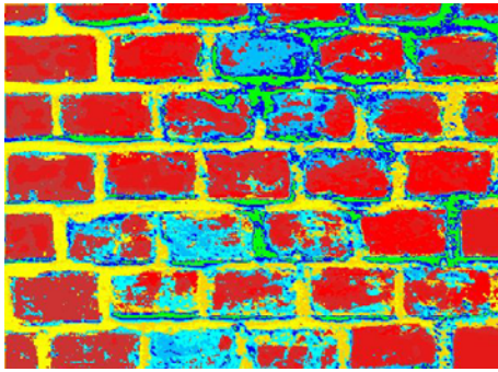
Abb. 6: Ergebnis der unüberwachten pixelbasierten Klassifizierung (Clusteranalyse)
