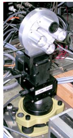
Abb. 17: Messkopf des multispektralen Laserscanners
