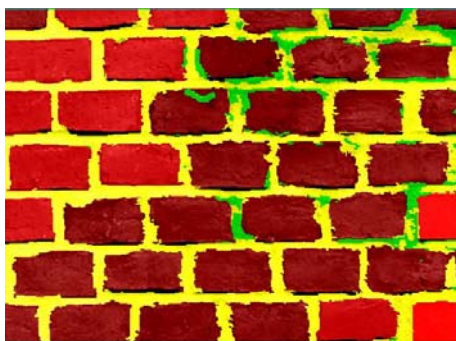
Abb. 10: Ergebnis der objektbasierten Klassifizierung, Klassifikation von verwitterten, ungeschädigten Originalziegeln und neuen Ziegeln
