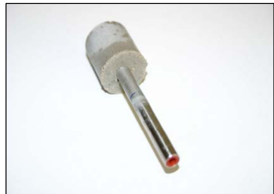
Abb. 5: Mörtelprüfling mit integriertem Sensorkopfmuster
