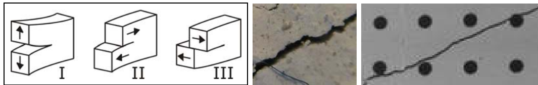
Bild 1: von links nach rechts: a) Rissöffnungsarten nach Irwin [Irw58] b) Risskanten c) Messmarken neben einem Riss
