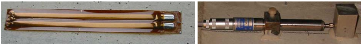
Bild 4: a) Dehnungsmessstreifen DMS b) Wegaufnehmer (induktiv)
