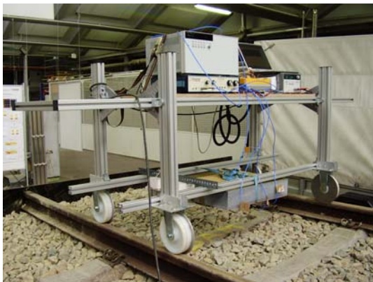
Abbildung 7: Prototyp des linearen Antennenarrays mit einem Sender und drei Empfängern
