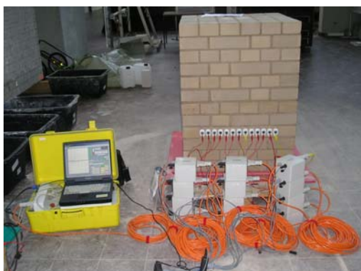
Abb. 8: SIP-Messung am Kalksandsteinprobekörper.
