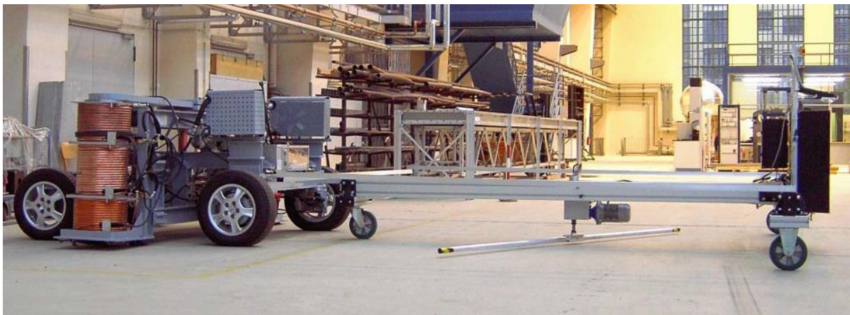
Abb. 10: Gesamtsystem zur Ortung von Spanndrahtbrüchen in Brückenplatten
