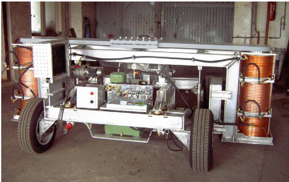
Abb. 6: Das elektromagnetische Joch, integriert in das dafür angefertigte Fahrzeug.
