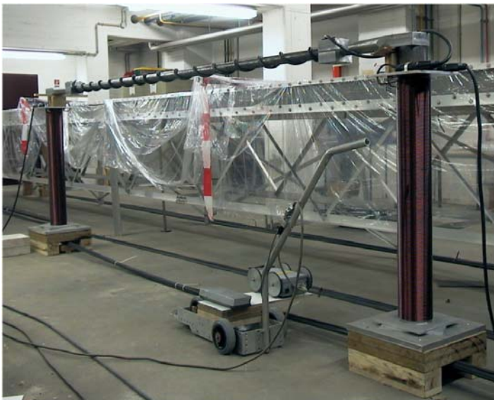
Abb. 2: Prototyp des Jochmagneten für die Spanndrahtbruchortung an Querspanngliedern.
