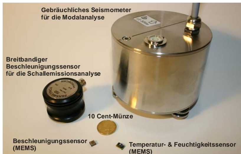
Abbildung 3: Konventionelle und MEMS-basierte Sensorik für das Bauwerksmonitoring
