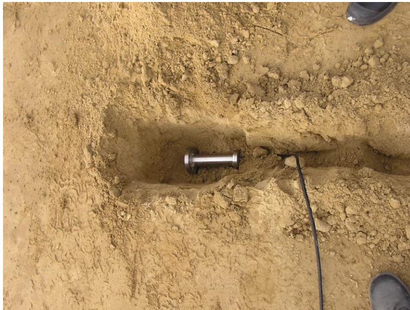
Abb. 2 Mikrowellen-Feuchtesensor beim Einbringen ins Planum einer Straße
