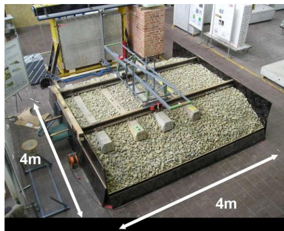
Abbildung 4: Schotterprobekörper, aufgebaut in einer Versuchshalle der BAM [7]
