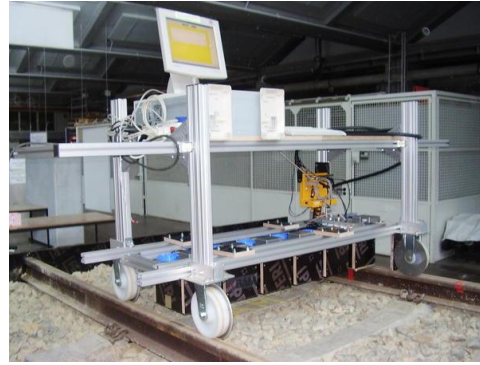
a) b) Abbildung 3: CMP/CRS mit Linear-Array (a) und Prototyp des Linear-Arrays in "Saferail" (b)
