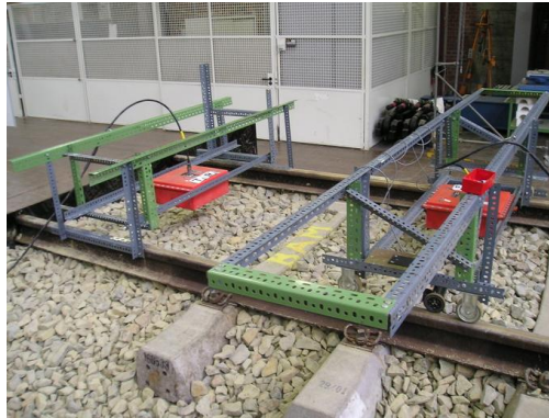
Abbildung 5: Multi-Off-Set Messaufbau mit einem statischen und einem beweglichen Sender auf einem Schotter-Probekörper der BAM
