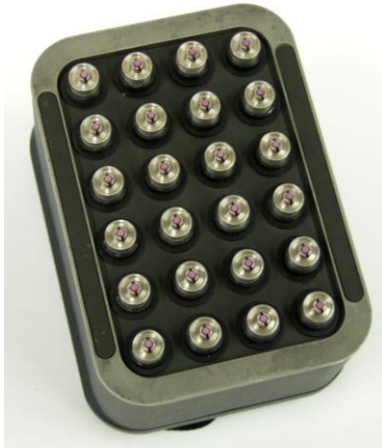
Abbildung 1 Ultraschall-Prüfkopfarray ACSYS M2502 [3] mit 24 einzelnen Punktkontakt-Prüfköpfen. Jeweils 12 sind parallel als Sender bzw. Empfänger geschaltet
