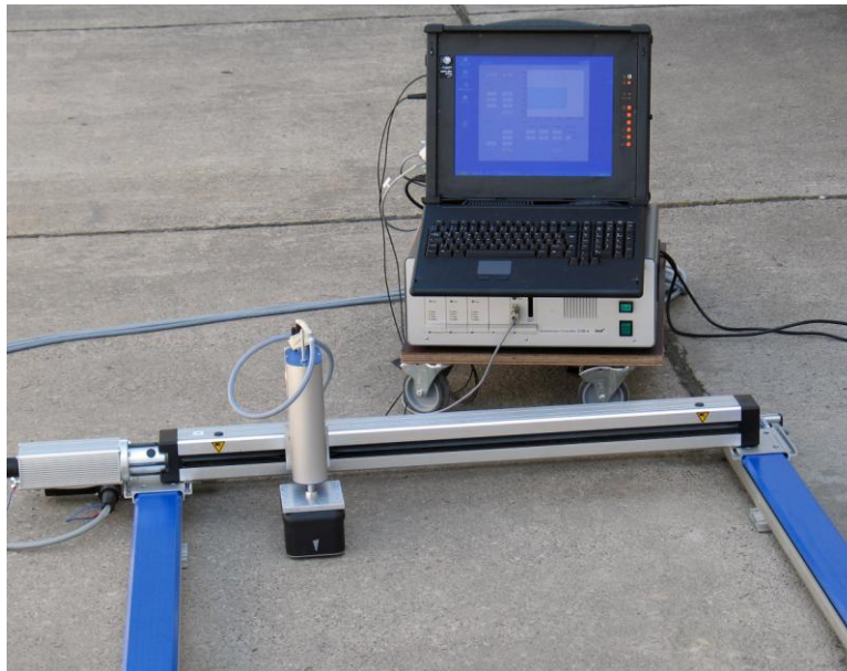
Bild 4. Messsystem und Scanner im 3D-Betrieb mit Trockenankopplung
