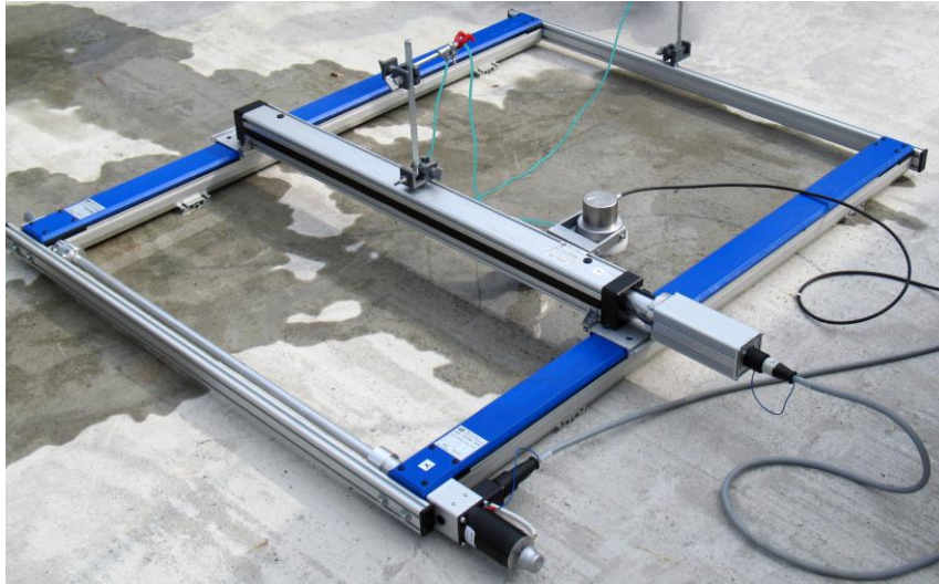
Bild 5. Scanner im 2D-Betrieb mit Wasserankopplung
