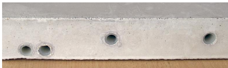
Bild 7. Seitenansicht des Estrichtestkörpers mit Heizungsschläuchen
