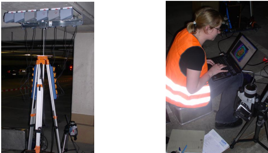
Abbildung 3 Erwärmungseinheit (links) und IR-Kamera mit angeschlossenen Messrechner (rechts) zur Durchführung der großflächigen Messungen (LGA Bautechnik GmbH)
