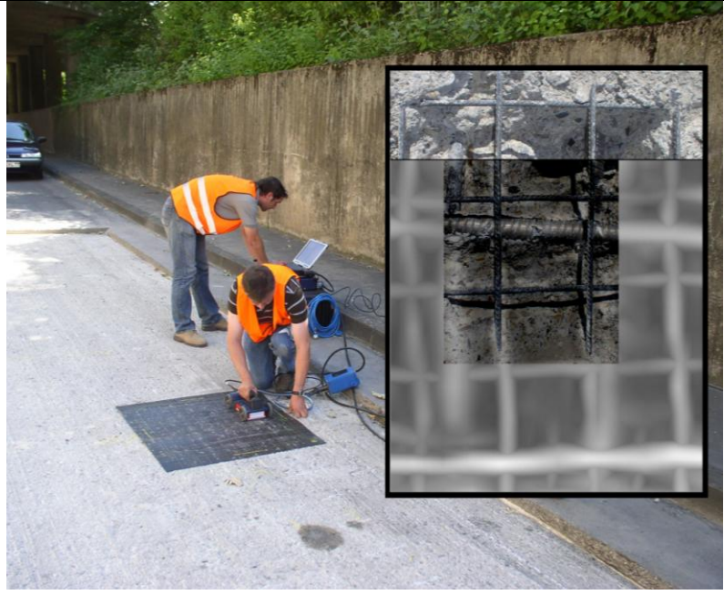
Abbildung 6: Radarmessung mit Ergebnissen, dargestellt als 3D-Tiefenbild
