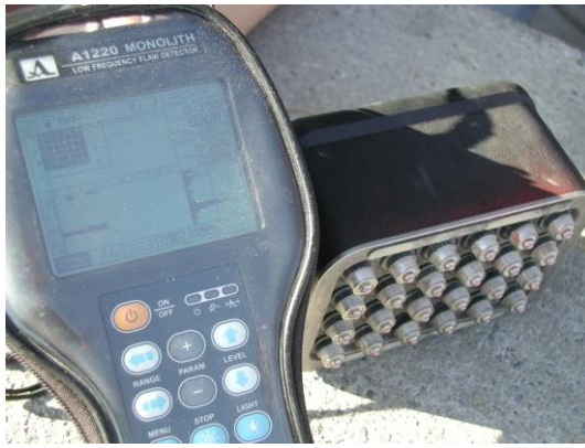
Bild 5: Ultraschall-Echo-Messgerät und Messkopf mit 24 Punktkontakt-Prüfköpfen
