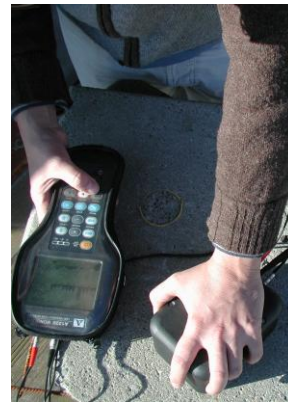
Bild 5: Ultraschall-Echo-Messgerät und Messkopf mit 24 Punktkontakt-Prüfköpfen
