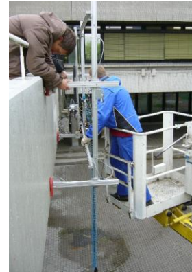
Abbildung 2 (a) Saugscanner beim Über-Kopf-Einsatz und (b) an vertikaler Fläche. (c) Der Saugscanner ermöglicht eine schnelle Montage.
