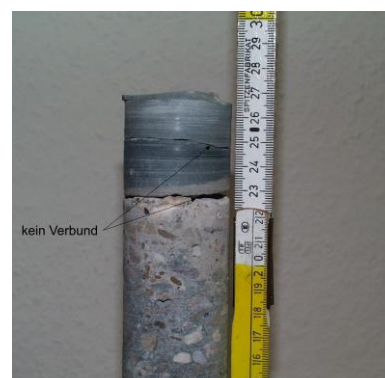
Bild 5 links: Vergleich der Messungen im Firstbereich vor und nach der Firstspaltverpressung [7] rechts: Bohrkern mit Injektionsgut der Firstspaltverpressung
