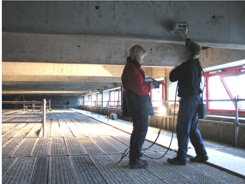
Abbildung 1. Ortung von Spanngliedern und Hohlstellen in Spannbetonbindern einer Sporthalle
