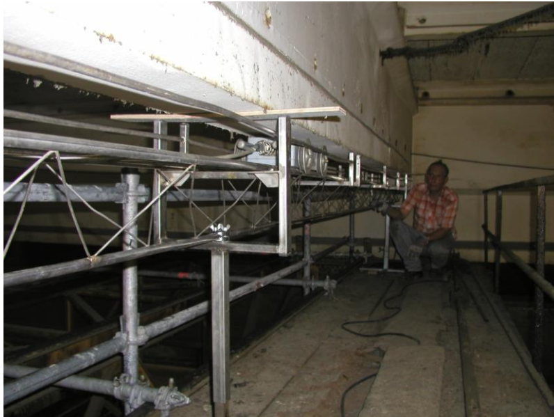
Abbildung 4. Spann Stahl-Rissortung mit dem schienengeführten Manetfeldverfahren
