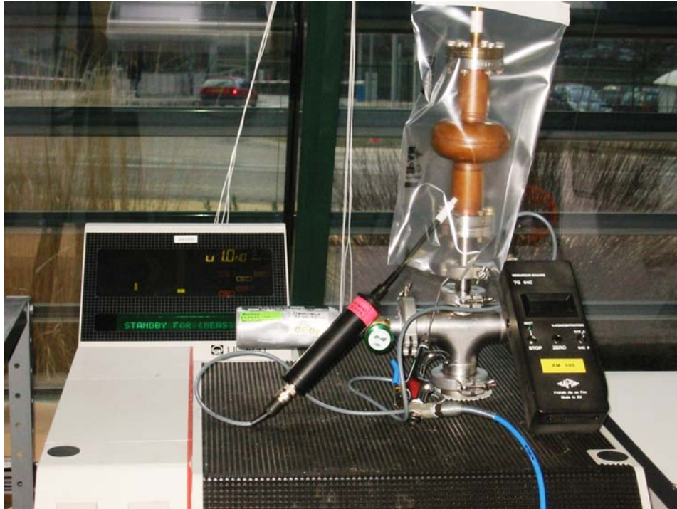
Montage d'un test en global hélium sous vide
