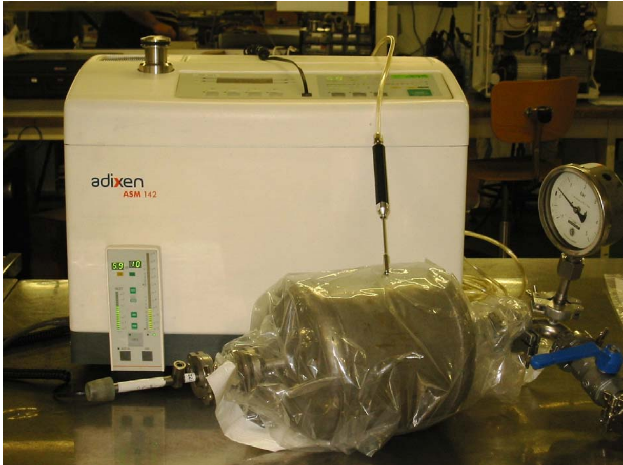
Réservoir en test avec un spectromètre de masse muni d'une sonde renifleur
