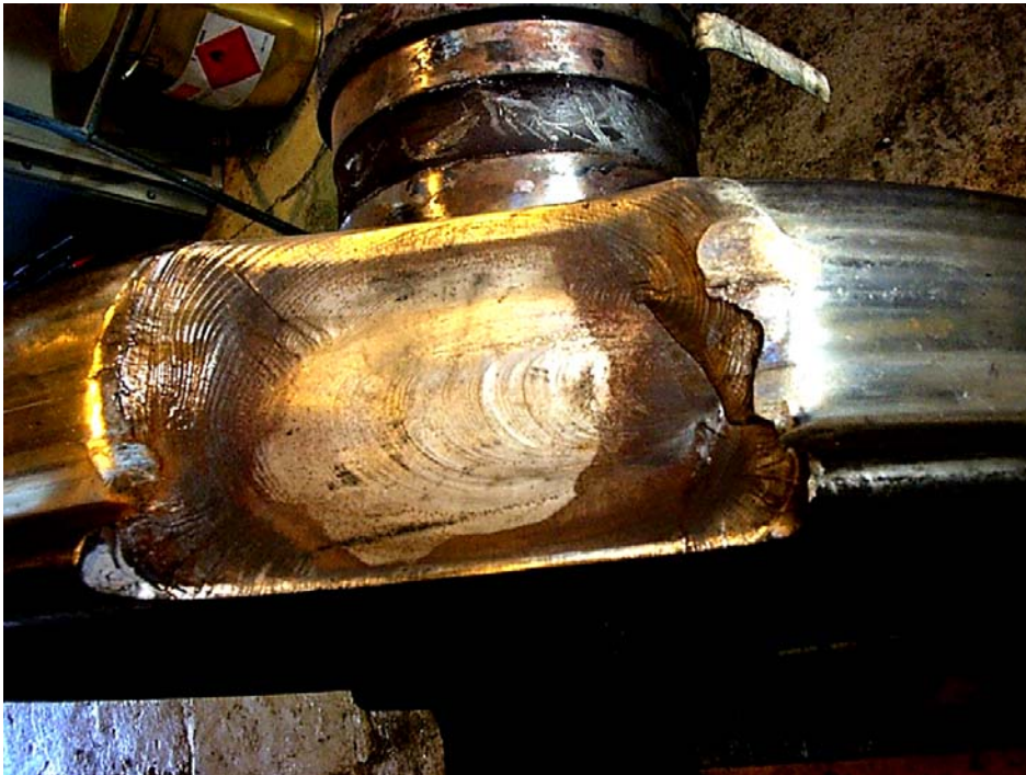
Fissuration parallèle à la table de roulement ayant conduit à la perte d'un secteur de roue.
