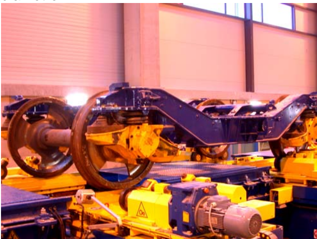
Bogie avec roues étalon
