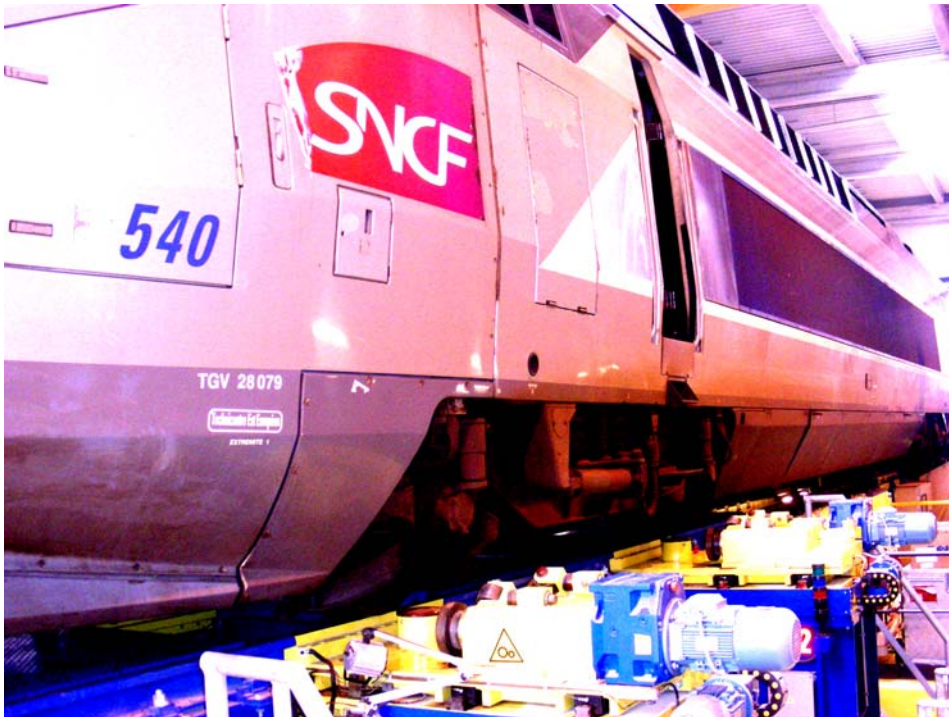
Passage de la rame au contrôle des roues
