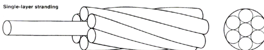
Figure 1: Géométrie du toron T15,7 composé d'un fil central et 6 fil hélicoïdaux
