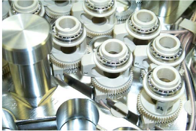
Figure 2: Détail du système de rotation des capteurs UT
