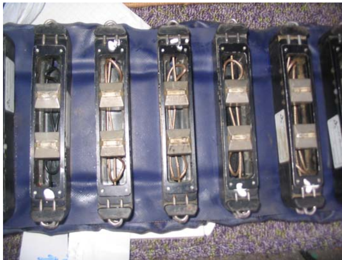
Figure 5 – Arrangement des modules capteurs sur un anneau souple
