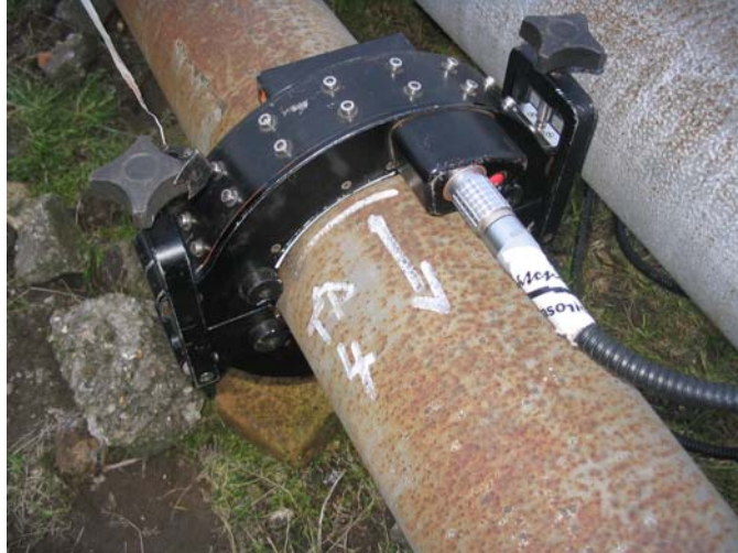
Figure 3 – Anneau rigide pour un tube Ø 4", en deux demi-parties contenant les capteurs
