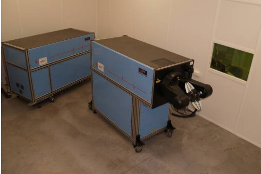
Les unités laser + scanner du LUIS dans la pièce d'inspection
