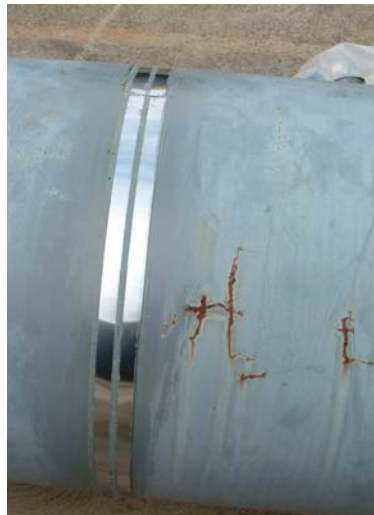
Figure 3 – Vue du feuillard à effet magnétostrictif résiné sur le pipe
