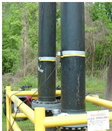
Figure 4 – Vue complète du transducteur à effet magnétostrictif avec sa bobine d'excitation
